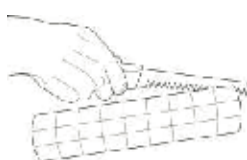
Se è necessario, effettuare un taglio longitudinale del manicotto per consentire l'alloggiamento del tubo
